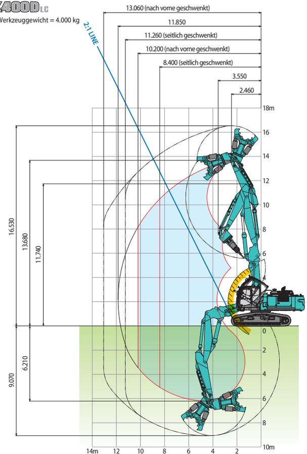
Arbeitsbereich mit Kabinen-Kollisionsschutzsystem
